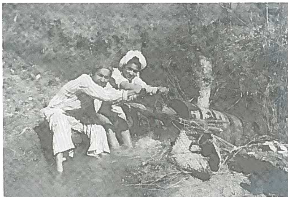
Fig. 19. Archimedes' snegl bruges stadigvæk i Egypten.
